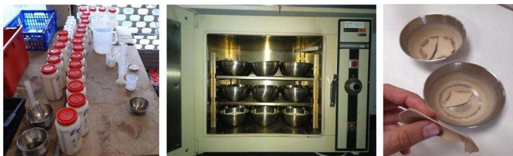
Figura 6. Detalle del procesado de aguas y medida de sólidos disueltos en el bidón del ensayo de cubierta vegetal frente a laboreo llevado a cabo en Elvillar (Araba) desde 1/04/20 hasta 31/03/2022.
