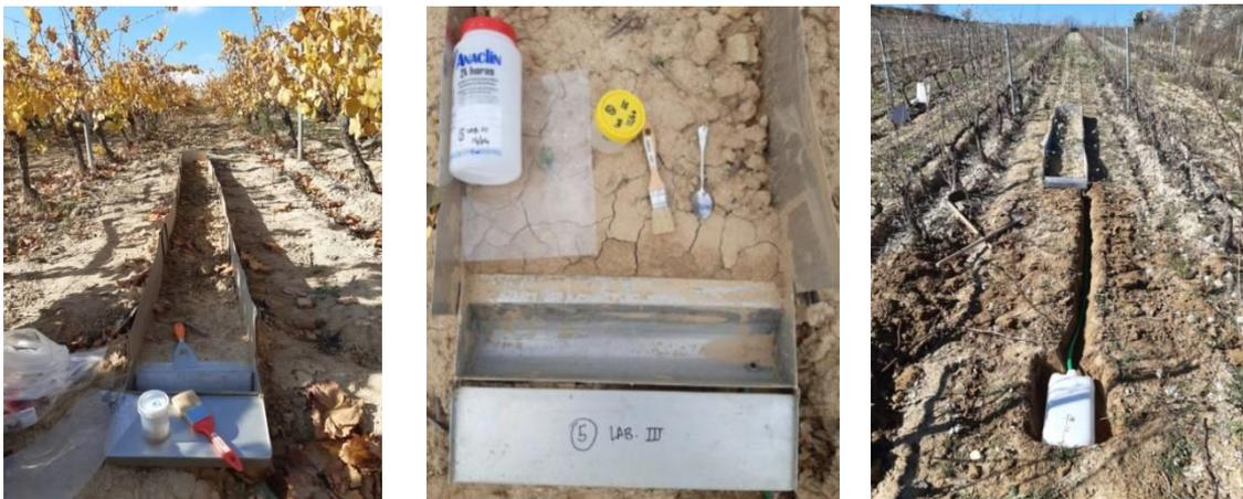
Figura 4 Instalación de las micro parcelas experimentales de medida de erosión, con cajas Gerlach y bidón de almacenaje de agua del ensayo de cubierta vegetal frente a laboreo llevado a cabo en Elvillar (Araba) desde 01/04/2020 hasta 31/03/2022.
