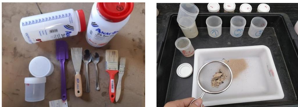
Figura 5. Detalle del material utilizado en el proceso de recogida de tierras en la caja Gerlach del ensayo de cubierta vegetal frente a laboreo llevado a cabo en Elvillar (Araba) desde 1/04/20 hasta 31/03/2022.
